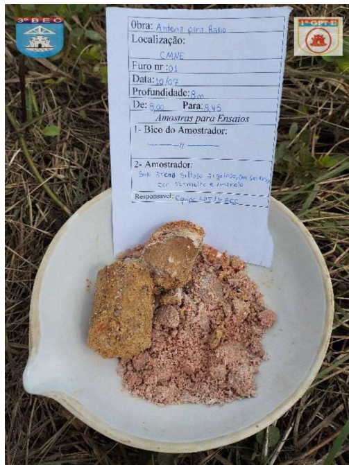
FURO 01 – PROF:8,00 PARA 8,45 - SOLO ARENO SILTOSO ARGILOSO, COM SEIXOS, COR VERMELHA E AMARELA.
