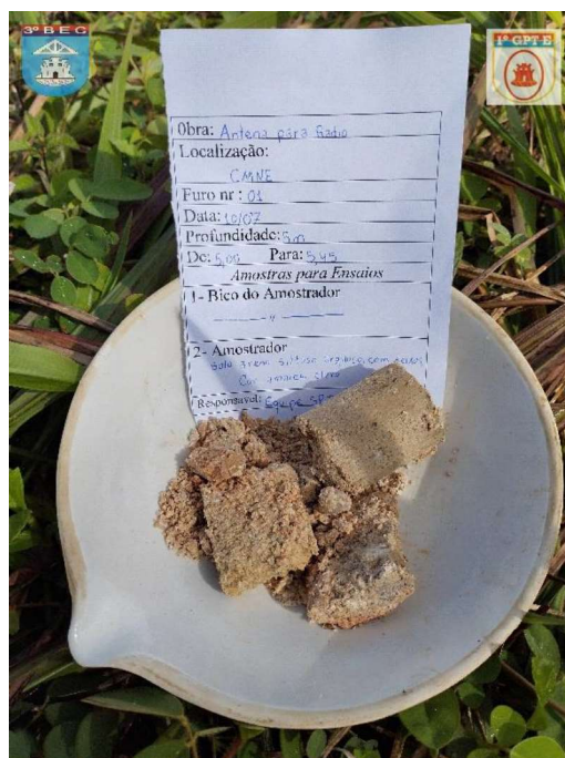
FURO 01 – PROF:5,00 PARA 5,45 - SOLO ARENO SILTOSO ARGILOSO, COM SEIXOS, COR AMARELA.
