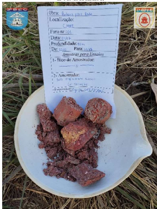
FURO 01 – PROF:8,00 PARA 8,45 - SOLO ARENO SILTOSO ARGILOSO, COM SEIXOS, COR VERMELHA E AMARELA.
