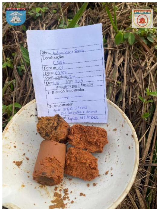
FURO 01 – PROF:2,00 PARA 2,45 - SOLO ARGILA SILTOSA, COR VERMELHA E AMARELA.
