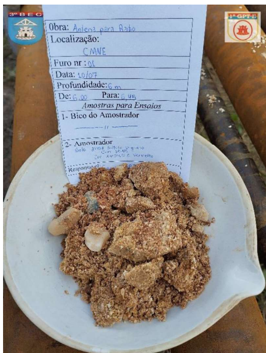
FURO 01 – PROF:6,00 PARA 6,45 - SOLO ARENO SILTOSO, COM SEIXOS, COR AMARELA E VERMELHA.
