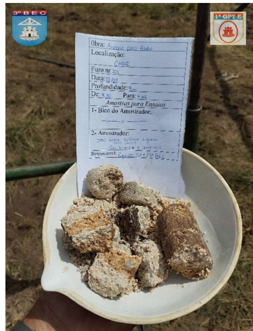
FURO 01 – PROF:9,00 PARA 9,45 - SOLO ARENO SILTOSO ARGILOSO, COM SEIXOS, COR BRACA AMARELA.
