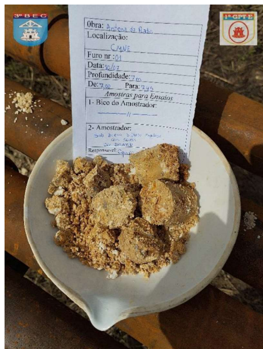
FURO 01 – PROF:7,00 PARA 7,45 - SOLO ARENO SILTOSO ARGILOSO, COM SEIXOS, COR AMARELA.
