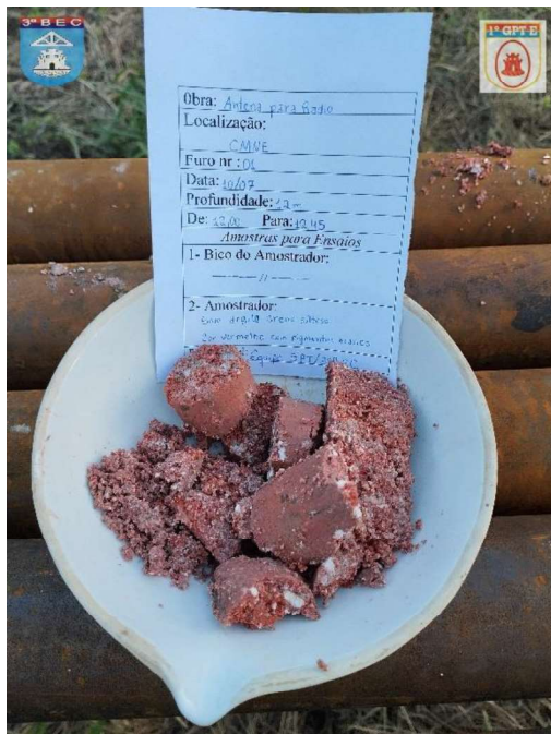
FURO 01 – PROF:12,00 PARA 12,45 – SOLO ARGILO ARENO SILTOSO, COR VERMELHA COM PIGMENTOS BRANCO.
