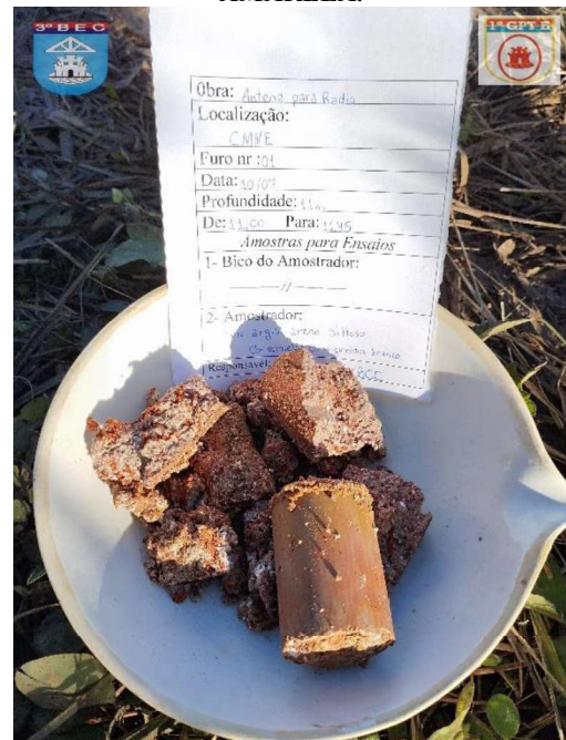
FURO 01 – PROF:9,00 PARA 9,45 - SOLO ARENO SILTOSO ARGILOSO, COM SEIXOS, COR BRACA AMARELA.
