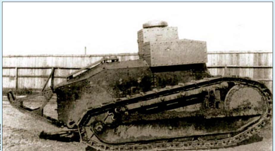
Foto 3: Renault FT 17 modelo TSF (Telegrafia sem fio), desprovido de torre giratória. Apenas um foi adquirido e usado no Exército Brasileiro
