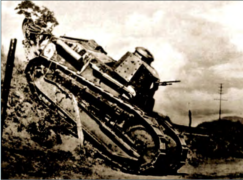
Foto 2: Renault FT-17 com torre rebitada Renault, armado com metralhadora Hotchkiss, calibre 7mm (este era o calibre usado no Brasil, na França era de 8mm), em ação na Revolução de 1924. Este carro possui o nome Colônia dos Dourados
