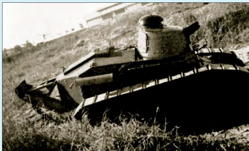
Foto 1: Renault FT-17 com torre fundida Berliet e armado com canhão Puteaux de 37mm, em manobras do Exército em 1940. Notar a ausência de emblemas
