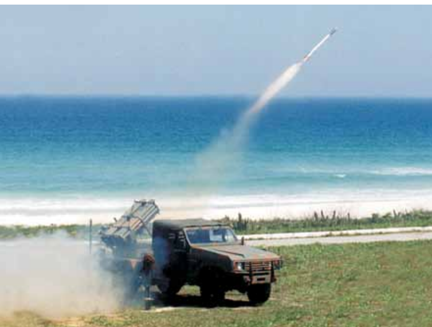
Sistema Astros Hawk, montado sobre um veículo Tectran ¾ ton modelo TT-1000, 4x4, disparando foguetes Skyfire 70. (Foto: Avibrás)
