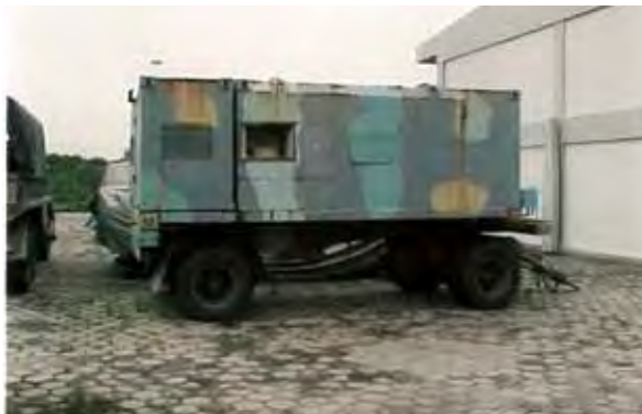
Protótipo do Shelter auto rebocado desenvolvido para operar o sistema Roland II, preservado no CTEx, no Rio de Janeiro. (Foto: autor)
