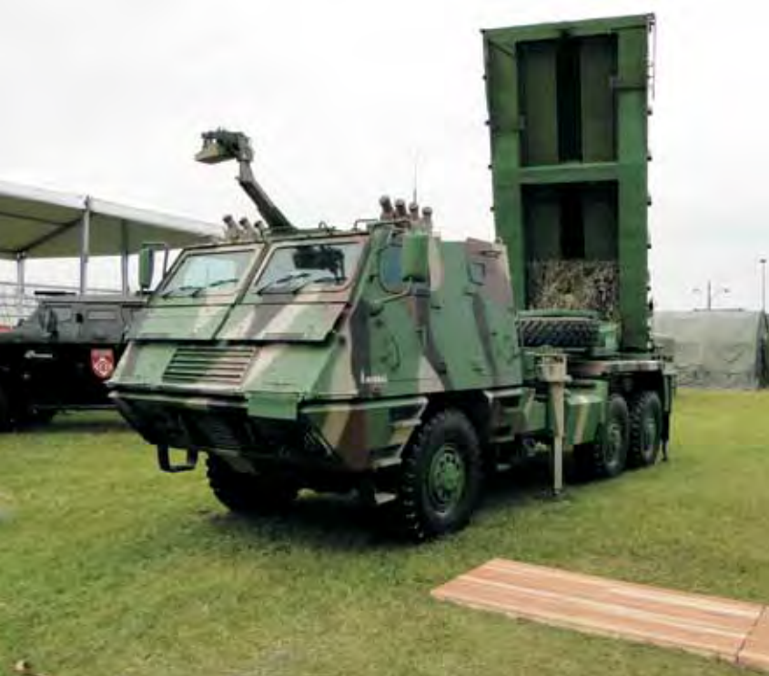
Unidade lançadora do Astros II versão MK-5 exportado para a Malásia, já com a nova configuração de chassi TATRA e cabine mais alongada. (Foto: autor)
