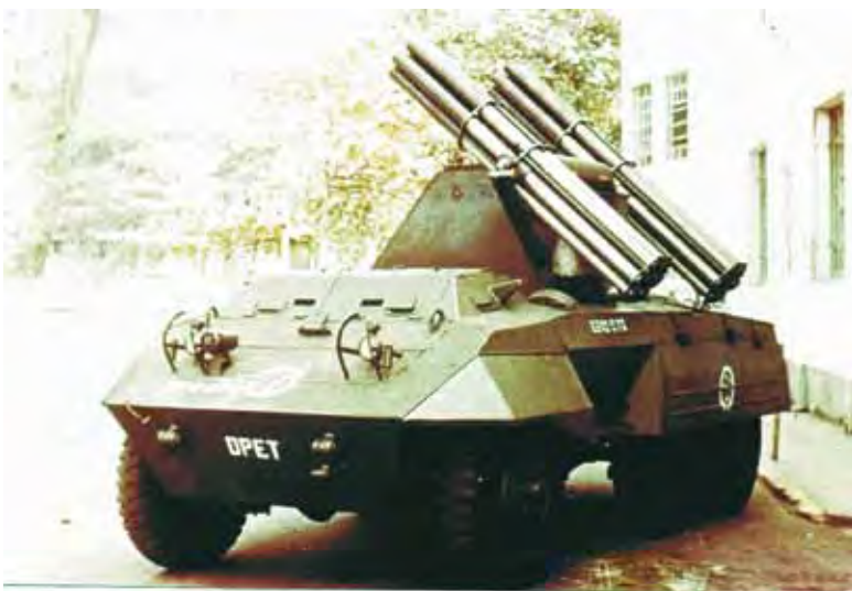
Lançador de foguetes montado sobre um M-20 6x6, cuja torre foi fabricada no Arsenal de Guerra da Urca, com catorze tubos lançadores, desenvolvido pelo DPET. (Foto: Coleção autor)
