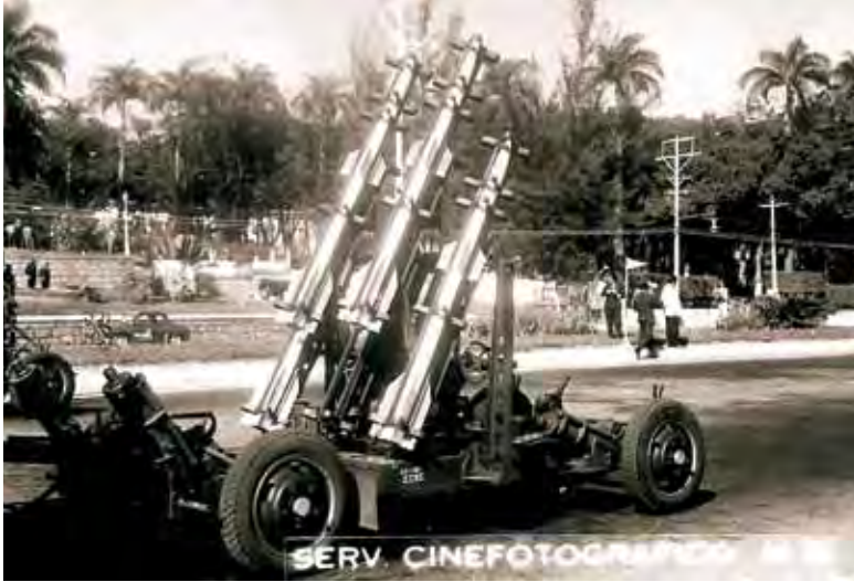
Lançador de foguete F-114-DE com cinco foguetes, montado sobre reparo Bofors 40/60 em desfile militar de 28 de junho de 1966. (Foto: Exército Brasileiro)
