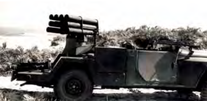
Fv-108-R com dez tubos montado sobre veículo 4x4 Jeep Willys Overland ¾ ton. (Foto: Coleção autor)
