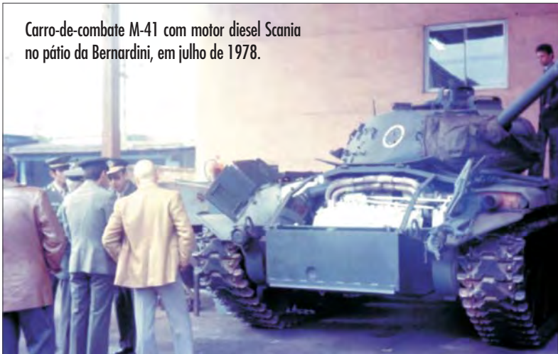
Vista da traseira do M-41 após a instalação do sistema de ventilação do motor Scania.
