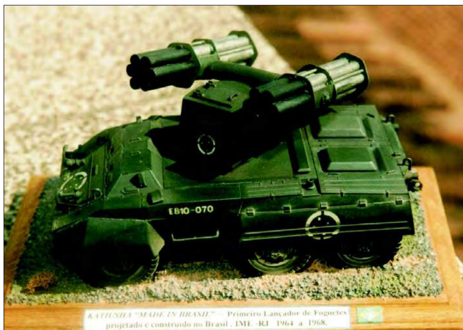
Miniatura de viatura lança foguetes desenvolvida pelo IME entre 1964 e 1968 e testada na Marambaia. Nem todos os artefatos e veículos desenvolvidos no Brasil sobreviveram até os dias de hoje, como é o caso desse lançador de foguetes de 81 mm, adaptado em um carro M-8. A função dos Museus é tentar recuperar essas informações de todas as formas possíveis. Para isso, o uso de miniaturas detalhadas como essa são uma ferramenta fundamental. Miniatura de autoria de Expedito Carlos Stephani Bastos
